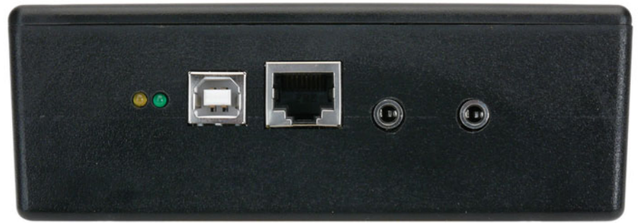
Figuur 2. De verzwakker-unit. V.l.n.r. de gele LED geeft pc-communicatie aan, de groene LED geeft de voedingsspanning aan, daarnaast vinden we de USB-aansluiting en de RJ45-aansluiting voor het drukknoppenkastje, dan komt de signaalgang en helemaal rechts ten slotte zit de aansluiting voor de hoofdtelefoon.
